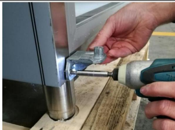
**14.** Die im Inneren der Tür eingesetzte Feder durch eine vollständige Umdrehung gegen den Uhrzeigersinn spannen.
