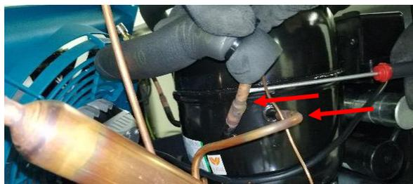
5. Den Verdichter entfernen, dazu die entsprechenden Verankerungssysteme betätigen.
