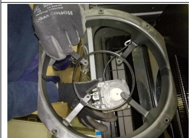
10. Den Lüftermotor auswechseln und wieder am Förderer positionieren.
