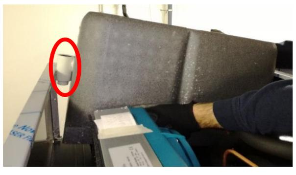
5. Die sechs Schrauben, die den Lüfter am Verdampfer festhalten, mit einem Schraubendreher lösen.
