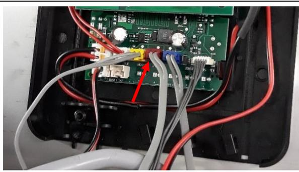
5. Die Anschlüsse des Fühlers von der Platine lösen.
