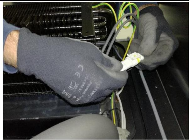
**11.** Den Heizkörper auswechseln, dazu die Kabel in die entsprechenden Bohrungen an der Seite des Verdampfers einführen.
