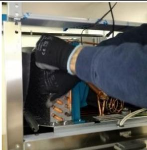
6. Die Befestigung der Filterplatte am Verflüssiger mit den Federn sichern.
