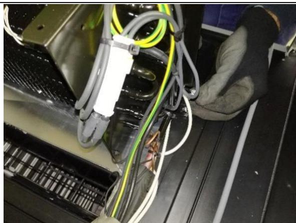
7. Das Selbstklebeband entfernen, das den Heizkörper an der Basis festhält.
