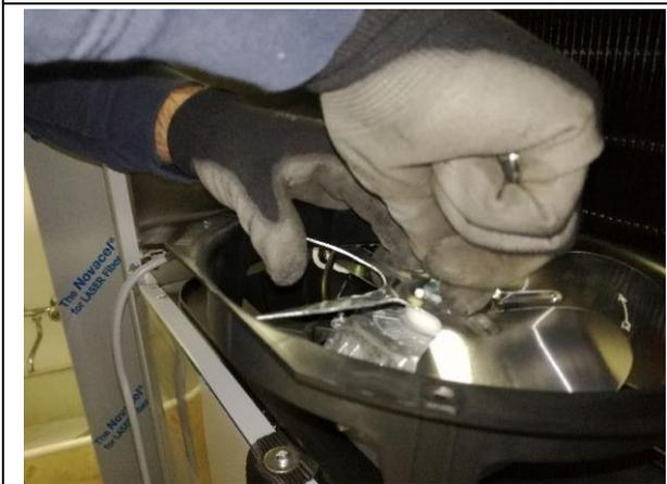
8. Die vier Schrauben, die den Lüftermotor am Förderer festhalten, mit einem 7mm Rollgabelschlüssel lösen.
