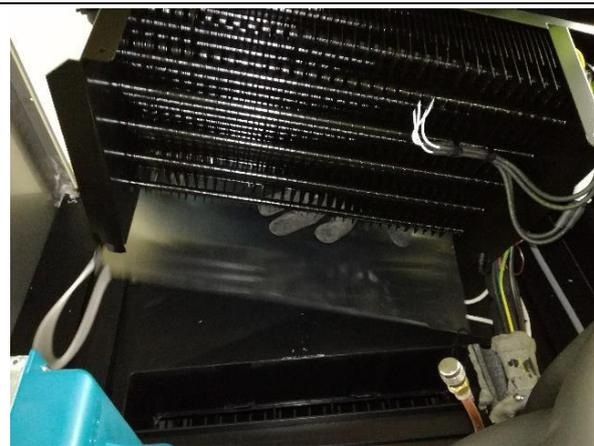
9. Die Schraube zur Befestigung des Beckens lösen.
