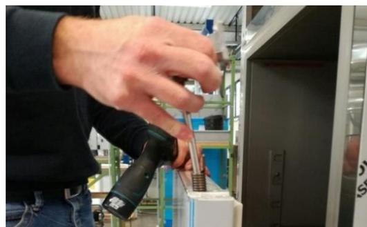
5. Das obere Scharnier mithilfe eines Schraubendrehers mit Spitze  $\varnothing 7$ , wie in der Abbildung angezeigt, durchbohren, um die Bohrung links zu öffnen.
