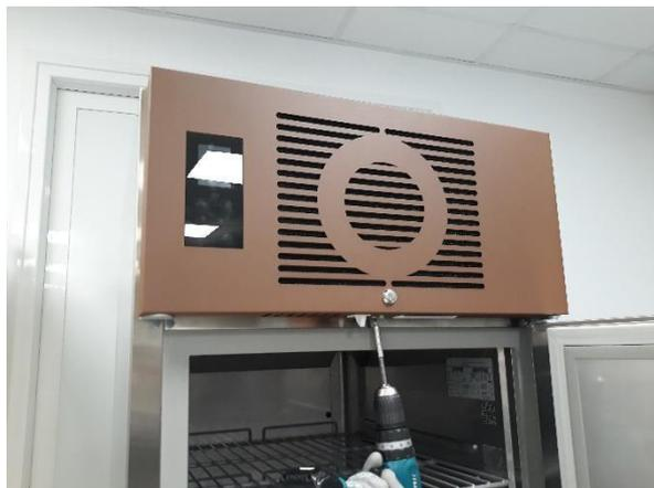
2. Die zwei Schrauben zur Befestigung des oberen Scharniers mit einem Kreuzschlitzschraubendreher lösen.
