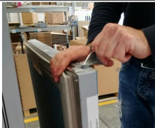
**15.** Das obere Scharnier am Chassis befestigen.
