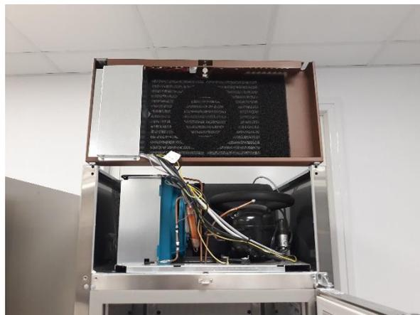
3. Die vier Schrauben zur Befestigung des Förderers am Verflüssiger lösen.
