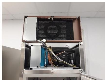
3. Das Gas mit dem entsprechenden Rekuperator zur Lagerung des Kältemittels von der Anlage entfernen.
