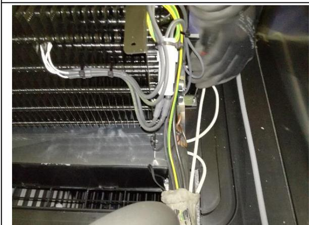
**14.** Den Verdampfer mit den Befestigungsschrauben an der Basis befestigen.
