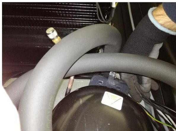
10. Die Schellen befestigen und den Fühler an der Platine anschließen.
