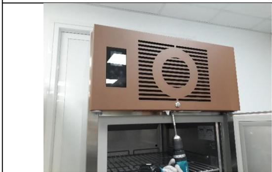
2. Die Frontplatte anheben und dabei darauf achten, dass diese am hinteren Chassis befestigt wird.
